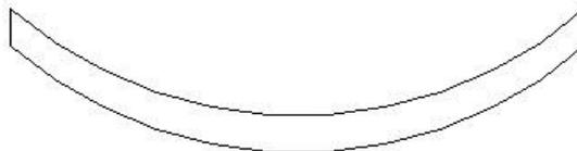
Figura 3.12. Configuración plano-cóncavo para las superficies del transductor y reflector.
